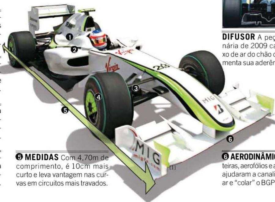
**5 MEDIDAS** Com 4,70m de comprimento, é 10cm mais curto e leva vantagem nas curvas em circuitos mais travados.
